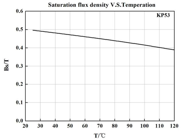
以上数据是根据标准样环  $\phi 25 \times \phi 15 \times 5.0$  获得的典型数据，有关产品的具体性能会在此基础上有所调整。
