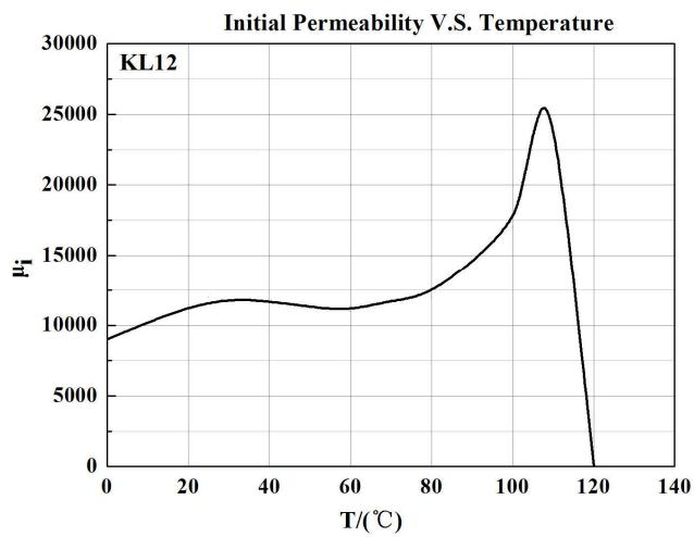
以上数据是根据标准样环  $\varphi 25 \times \varphi 15 \times 7.5$  获得的典型数据，有关产品的具体性能会在此基础上有所调整。
